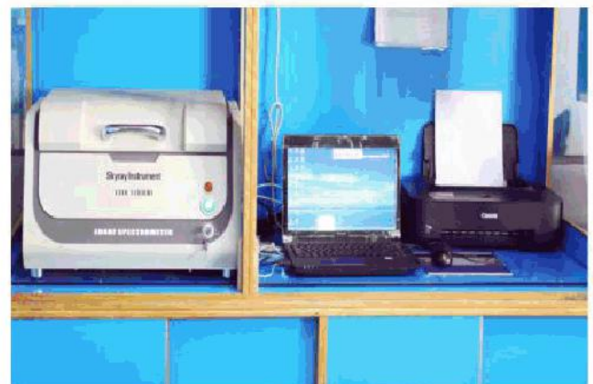
XRF环保测试仪 XRF RoHS Tecter 检验ROHS和卤素。 Test ROHS and halogen.
